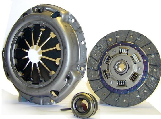
potisni ležaj, košara i tarva ploča spojke
